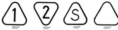
Abb. 9: Weitere Gütezeichen des DAMW nach der VO vom 12.6.1950. Anstatt der drei Nullen wurde die Nummer jener Prüfdienststelle eingetragen, die die Produktprüfung durchgeführt hatte bzw. die Betriebsnummer des Herstellers. (Deutsches Amt für Meßwesen und Warenprüfung: DAMW, 1966, S.6)
