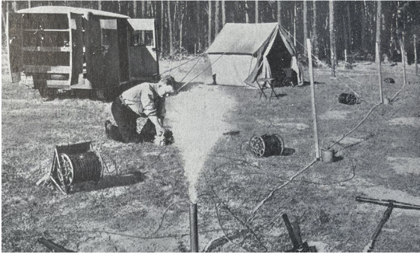
Abb. 39: Refraktionsseismisches Verfahren. Zündung der Sprengladung (im Vordergrund), an den Fluchtstäben stehen die Geophone, der Pkw enthält u.a. den Oszillographen für die Zeitmessung, der mit den Geophonen verbunden ist. 2020
